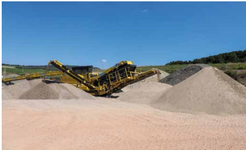
Die an eine Hydra gemahnende, imposante Brecheranlage, welche Mischabbruch in einem Arbeitsgang in Granulate verschiedener Körnungen bricht und diesen Bruch dann über mehrere, weit ausladende Förderbänder auch gleich sortenrein separiert.
